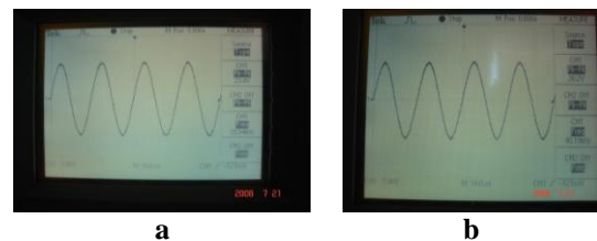
Gambar 17. Bentuk sinyal pada jarak minimal (a) dan maksimal (b)
