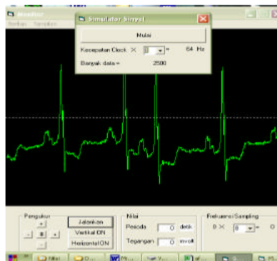
Gambar 5. Tampilan simulator untuk kasus atrial fibrillation
